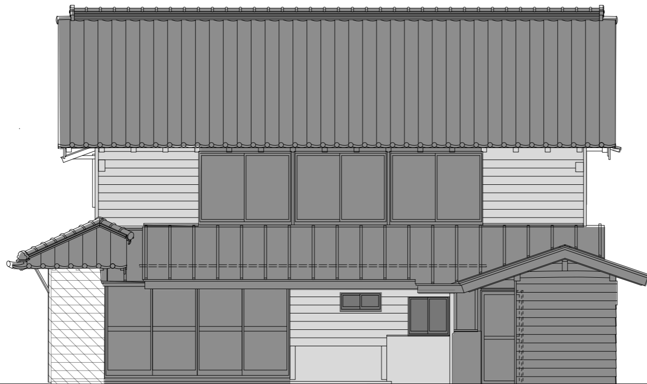
解体撤去概要 北側立面図 S=1 : 50
