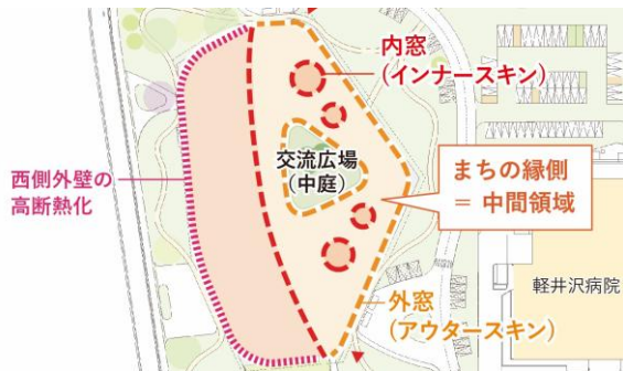
図 2-3: 高い断熱空間となる「まちの縁側」
