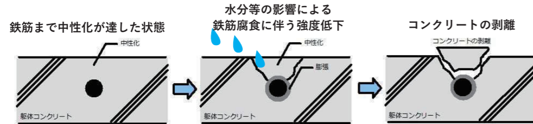
図.コンクリート中性化による鉄筋腐食の発生過程略図
