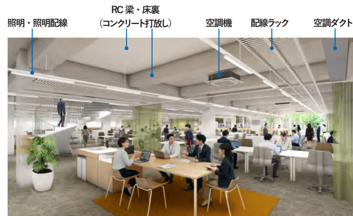
図：吊天井レスの執務室イメージ
