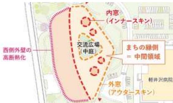
図 2-3: 高い断熱空間となる「まちの縁側」
