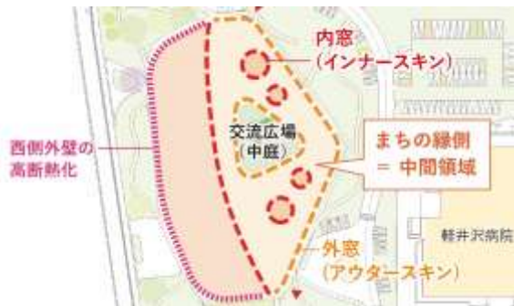
図 2-3: 高い断熱空間となる「まちの縁側」
