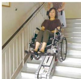
写真 5-4. 可搬式階段昇降機
